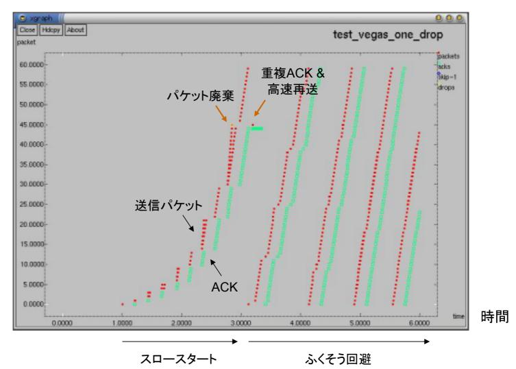
NS (Network Simulator) によるシミュレーション例
