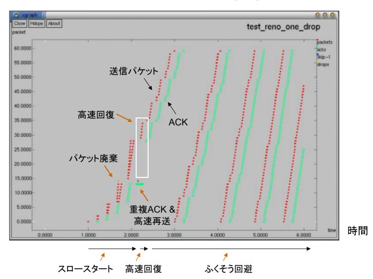
NS (Network Simulator) によるシミュレーション例
